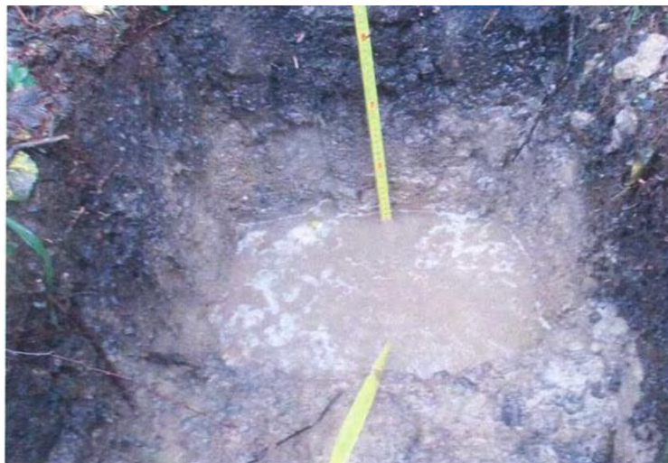
Рисунок 5.2.3.1 Грунтовые воды (ГВ-2Д)
